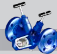
Le poste de purge compact CONA® "All-in-One" avec robinets d'arrêt (inclus robinets d'arrêt, filtre interne, clapet anti-retour : robinet de purge/ vidange optionnel)
