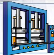
硫化工序 - 胎胚在高达 22 bar 的压力下，在平板硫化机中进行硫化。
