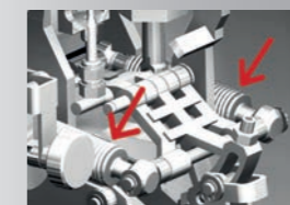
Dauerfest ausgelegte Federn aus Inconel, zur Vermeidung von Funktionsstörungen.
