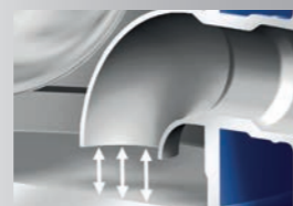
Tief liegender Eintritt in Förderleitung – zur Vermeidung von Dampfeintritt in die Förderleitung.
