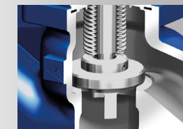
Zusätzliche Spindelführung über den Laternenkegel (höhere Differenzdrücke möglich).
