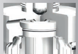
Düsenzentrierung nahe am Sitz – für ein präzises Ansprechverhalten. Wendekegel (beidseitig einsetzbare Dichtplatten); handlingstark und servicefreundlich.
