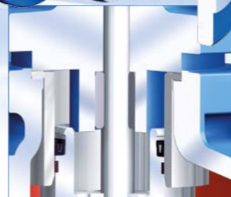
Opción de obturadores balanceados, reduciendo la fuerza de maniobra e incrementando la eficiencia
