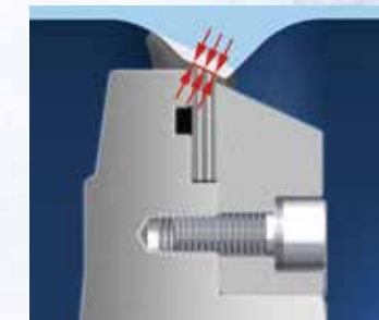
ZETRIX® 工艺系统蝶阀按照面密封原理, 通过执行器根据扭矩的变化来实现相应的密封压力
