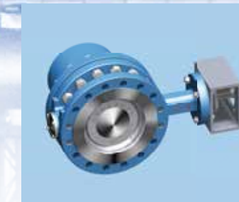
ZETRIX® 工艺系统蝶阀是多用途的阀门, 它的两侧均可以作为管路系统的末端阀门未使用, 执行器的连接符合ISO5211标准, 加长的阀帽设计便于保温材料的安装
